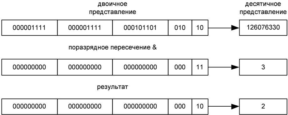
Рис. 7.6. Применение битовой маски и оператора поразрядного пересечения для извлечения формы графического примитива
